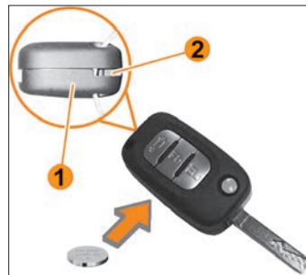
Рис. 8.10. Замена элемента питания ПДУ
