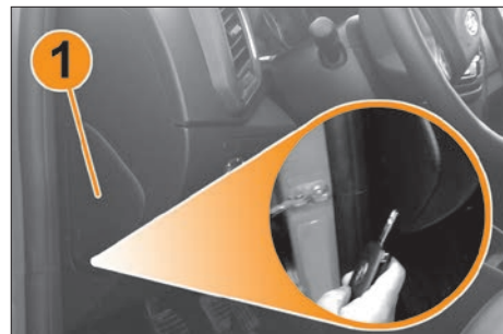
Рис. 8.29. Демонтаж крышки блока предохранителей и реле салона
