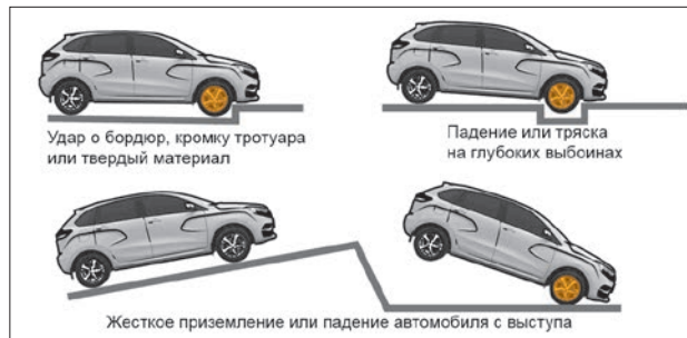
Рис. 2.14. Примеры ситуаций срабатывания подушек безопасности
